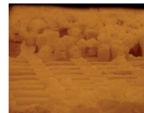
Deposits on the checkerwork 格子砖上的沉积物
